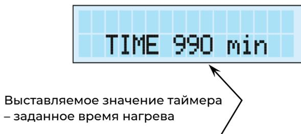
Рис. 9.4 Экран меню таймера
