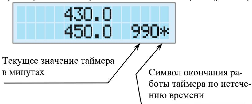
Рис. 9.3 Индикация таймера
